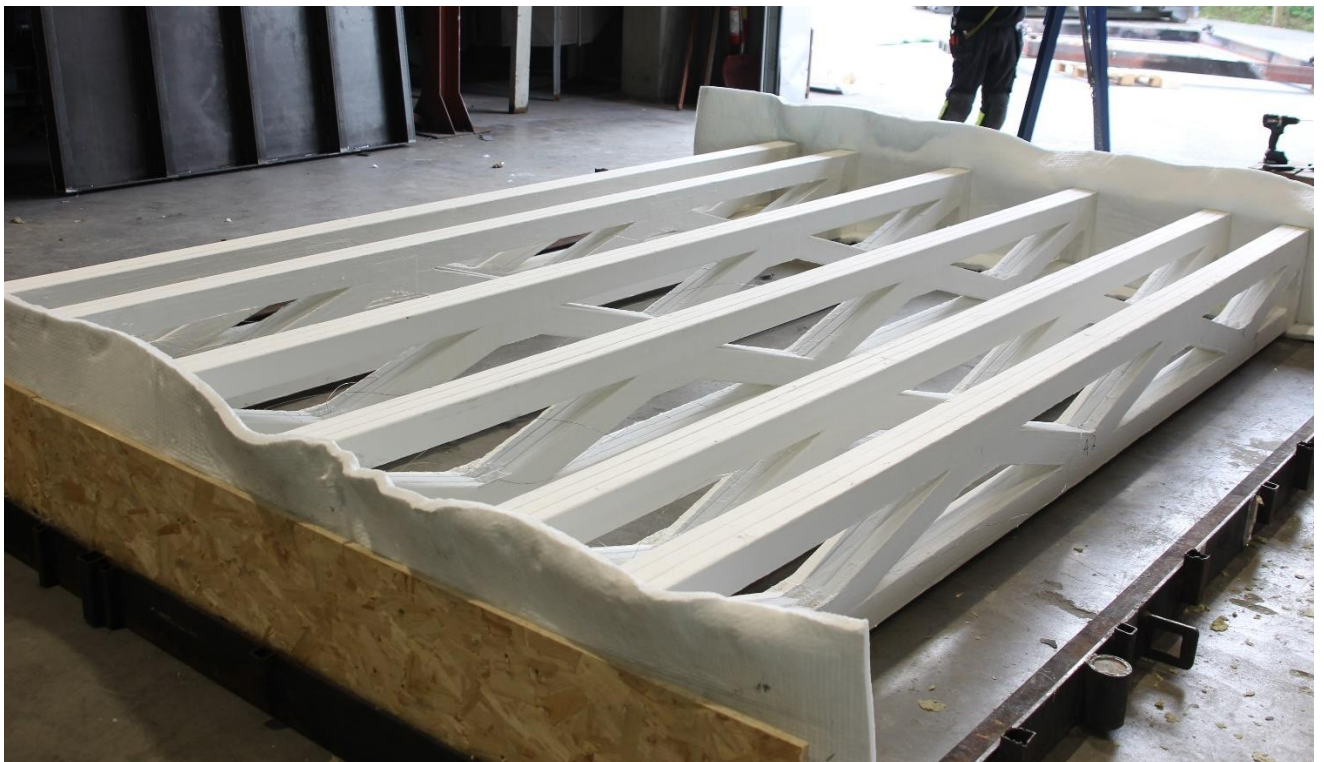
Figur 7 Takstolene ble plassert i en testramme av stål og skrudd til en trefiberplate i begge ender med AES-fiberisolasjon mellom takstolene og testrammen.
