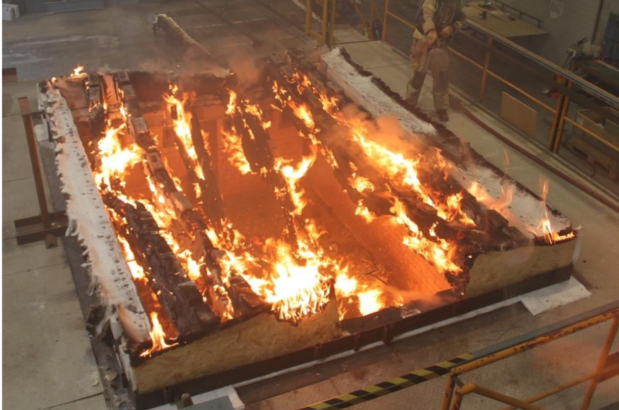
Figur 10 Takstolene brenner etter at Leca Byggeplank har blitt løftet av fra ovn, og alle takstoler har enten delvis eller fullstendig kollapset ned i ovnen.
